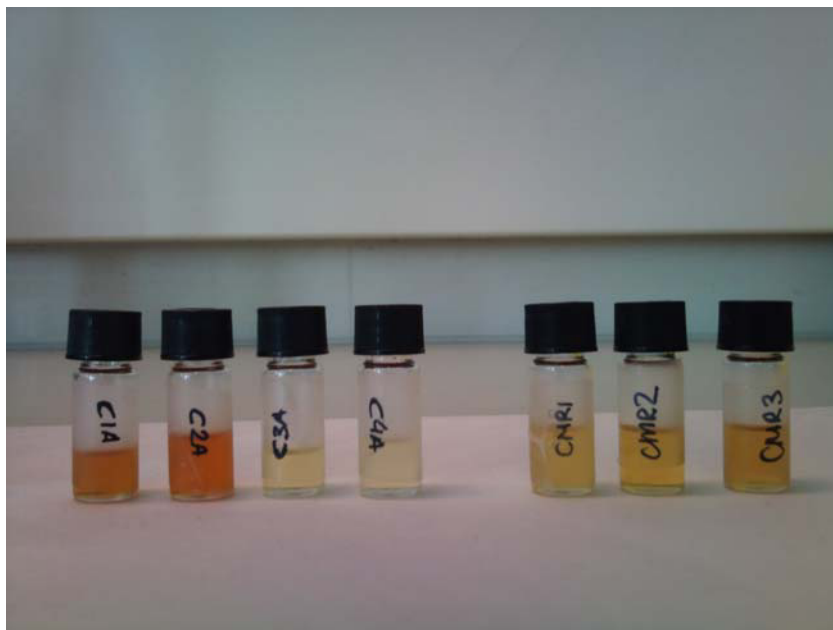
Foto 3.17. Extractos limpios procedentes de suelo agrícola y suelo certificado contaminado con hidrocarburos del petróleo
