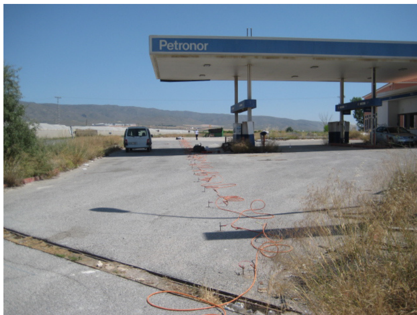
Foto 3.3. Perfil de tomografía P1 realizado en estación seca en EE.SS “Petronor”
