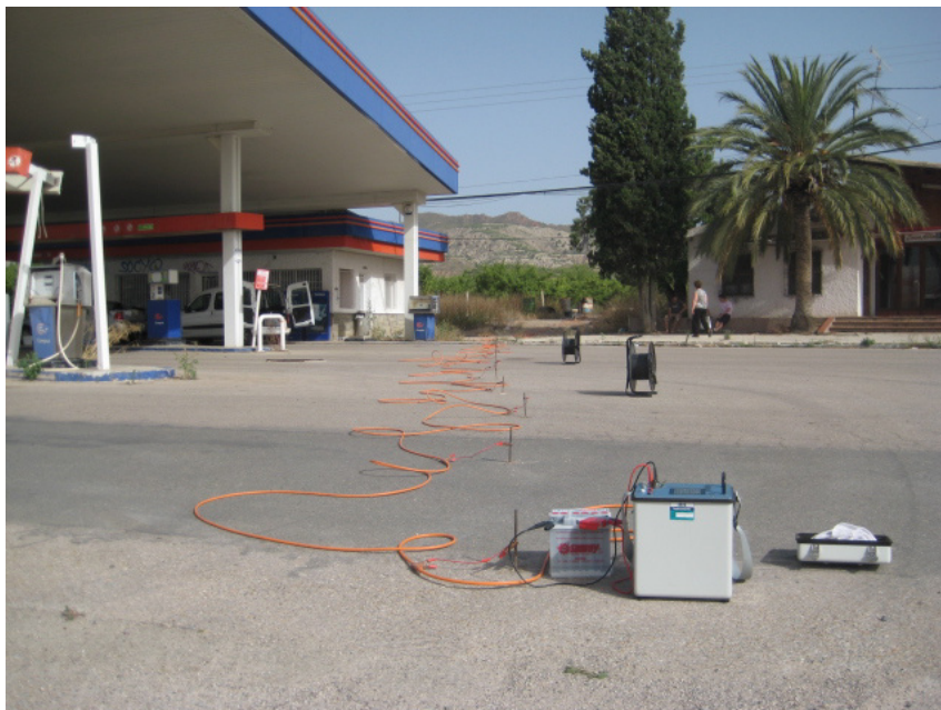
Foto 3.4. Perfil de tomografía P3 realizado en estación seca en EE.SS "Campsá"
