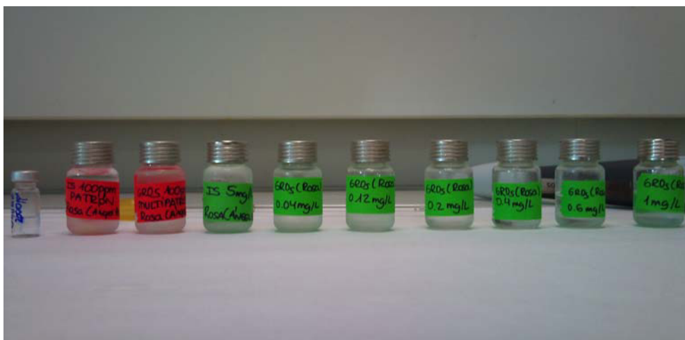
Preparación de niveles de calibración para cuantificación de GROs
