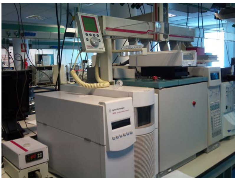
Foto 3.16. Equipo GC-FID utilizado para la puesta a punto y cuantificación de DROs y WOOs en muestras de suelo de las EE.SS
