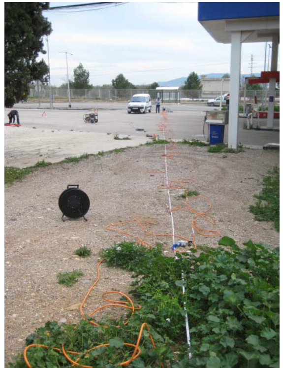
Perfil tomográfico 3 en EE.SS "Campsa". a) vista hasta electrodo 36; b) vista desde electrodo 18
