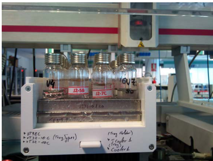
Foto 3.13. Viales headspace con muestra de subsuelo de la EE.SS “Petronor” en bandeja refrigerada VT32-20C - previo análisis
