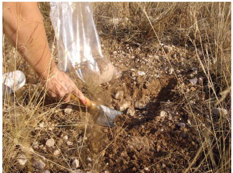
Toma de muestras superficiales de suelo en alrededores EE.SS "Petronor"
