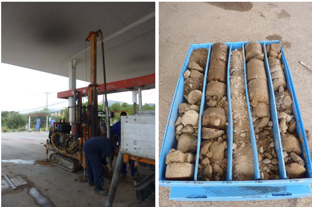
Foto4.3. Toma de muestras mecánica con extracción de testigo continuo en sondeo T1 (EE.SS “Campsa”)
