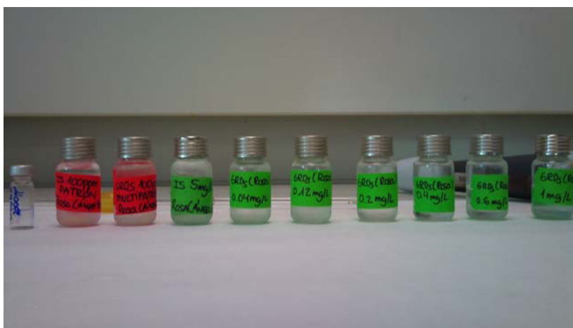
Foto 3.12. Multipatrón BTEX/GROs de 100 ppm y disoluciones de calibración para método BTEX/GROs de baja concentración
