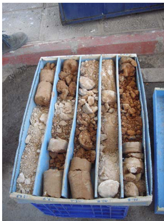
Fotografía 4.1. Toma de muestras mecánica con extracción de testigo continuo en sondeo J3 (EE.SS “Petronor”)
