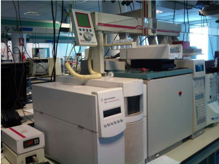
Equipo de cromatografía de gases con detector de fotoionización de llama GC-FID de Agilent
