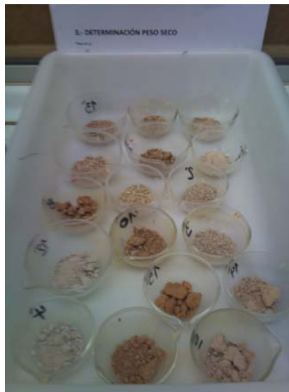
Foto 3.9. Crisoles con muestra de suelo para determinación del porcentaje de humedad
