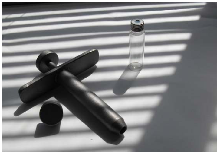
Foto 3.6. Muestreador de suelo diseñado para toma de muestras sin contacto manual y vial headspace de 22 mL
