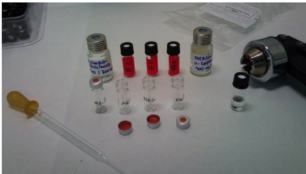
Foto 3.18. Preparación de extractos para medición en GC-FID
