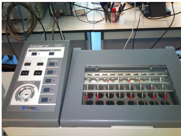
Foto 3.15. Equipo TurboVap II utilizado para la concentración de extractos a sequedad mediante corriente de nitrógeno
