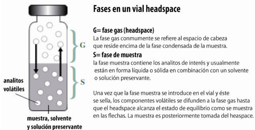
Figura 1.13. Fases en un vial headspace para análisis HS-GC (RESTEK, 2000 modificado por Rosales, R.)
