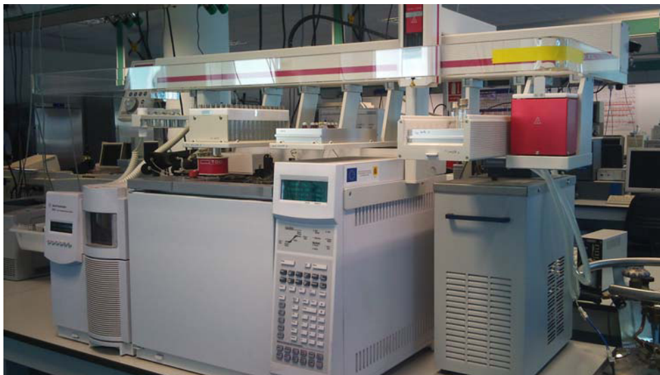
Foto 3.11. Equipo de cromatografía de gases- detector de masas (GC/MS) utilizado para la puesta a punto del método de cuantificación de BTEX/GROs en suelos
