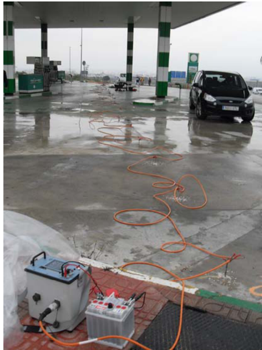
Foto 3.2. Perfil de tomografía P2 realizado en estación húmeda en EE.SS “El Trampolín”
