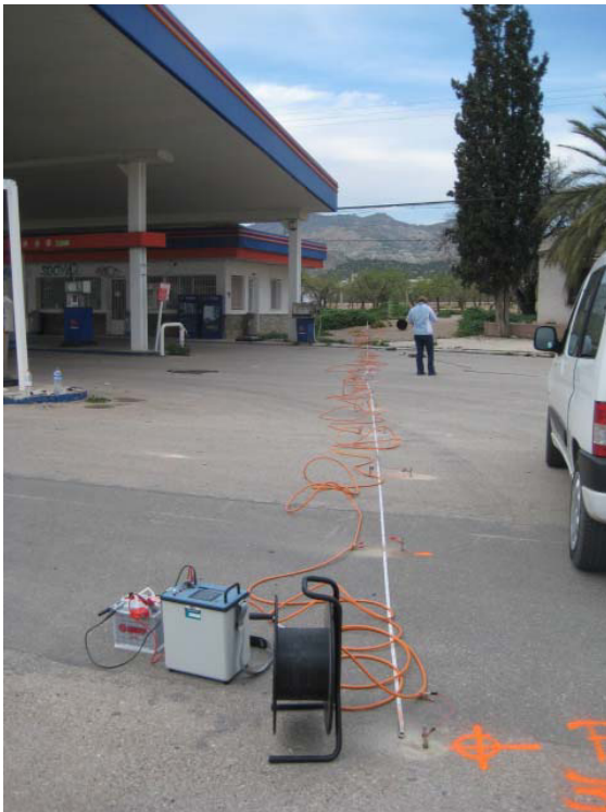
Perfil tomográfico 3 en EE.SS "Campsa". a) vista hasta electrodo 36; b) vista desde electrodo 18
