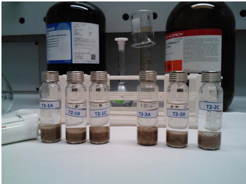
Muestras de suelo conservadas para introducción en HS-GC-MS para determinación de BTEX y GROs
