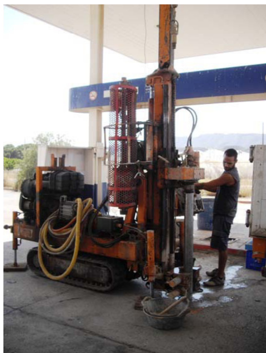
Fotografía 4.1. Toma de muestras mecánica con extracción de testigo continuo en sondeo J3 (EE.SS “Petronor”)
