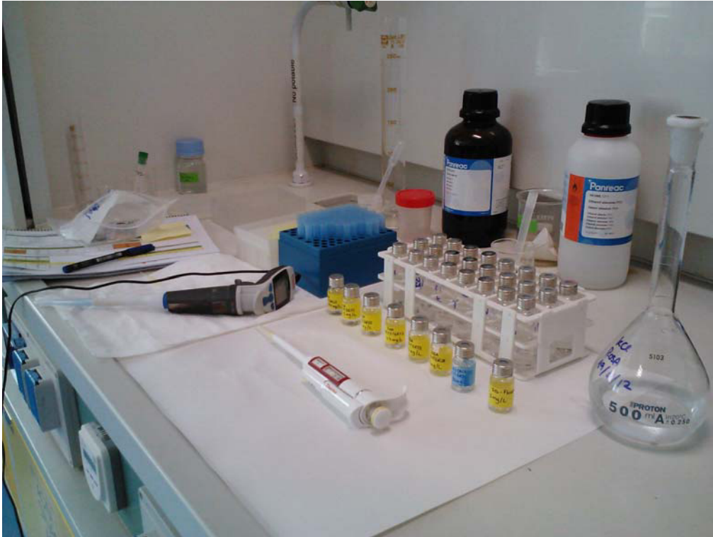
Preparación de muestras para determinación de GROs y BTEX
