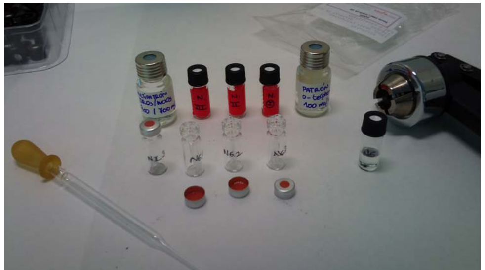
Preparación de niveles de calibración para cuantificación de DROs
