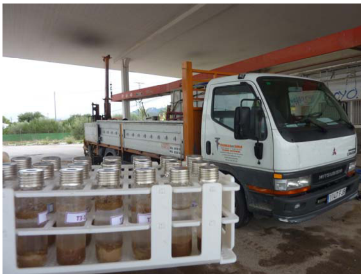
Foto 3.8. Viales de vidrio de 22 mL conteniendo las muestras de suelo y la MMS en la EE.SS de Totana
