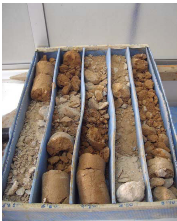
Foto 3.7. Caja de sondeo con muestras de subsuelo de 6 a 8.40 m de profundidad tomadas en la EE.SS Jumilla
