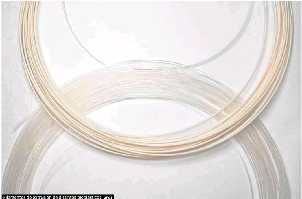
Filamentos de extrusión de distintos bioplásticos. UPCT
